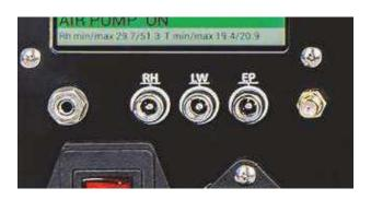
Il MiniOne è dotato di tre uscite ausiliarie, 12 Vdc, di cui due di allarme ed una di servizio, che sono le seguenti:
