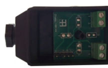
Dettaglio Interno versione con DIN-43650 con Morsetti
