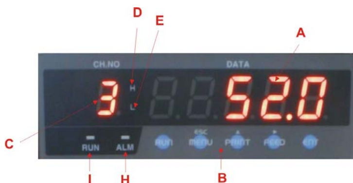
Figura -1.4.0.1 - Display &amp; Tastiera Frontale
