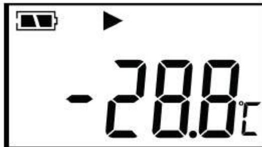
Premendo il tasto sinistro del Data Logger, lo strumento dallo stato di display spento, entra nello STATUS DISPLAY INTERFACE, la temperatura visualizzata è quella corrente, misurata in quel momento, quindi in questo stato:
