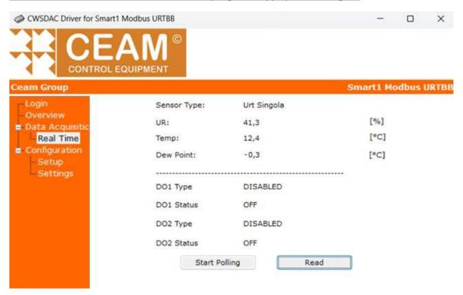
Rispetto alla configurazione precedente, in questo caso cambiano solo le informazioni visualizzate nel frame sotto la linea tratteggiata (parametri delle uscite digitali), ovvero:
