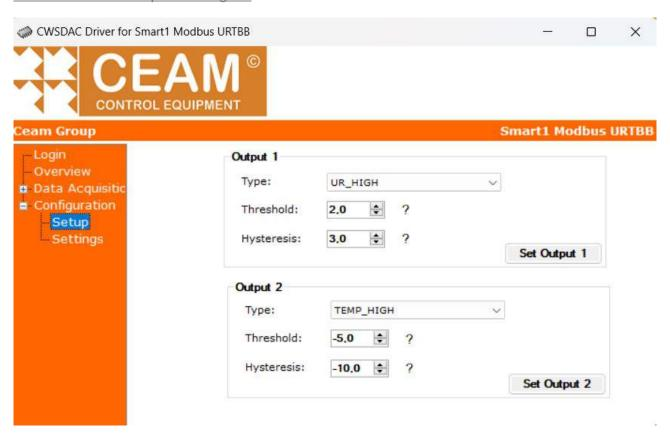
Tramite questa finestra è possibile definire il comportamento delle uscite digitali Otuput1 e Otuput2 semplicemente impostando i parametri (descritti qui sotto) e poi premendo il pulsante 'Set Output 1' o 'Set Output 2'.
