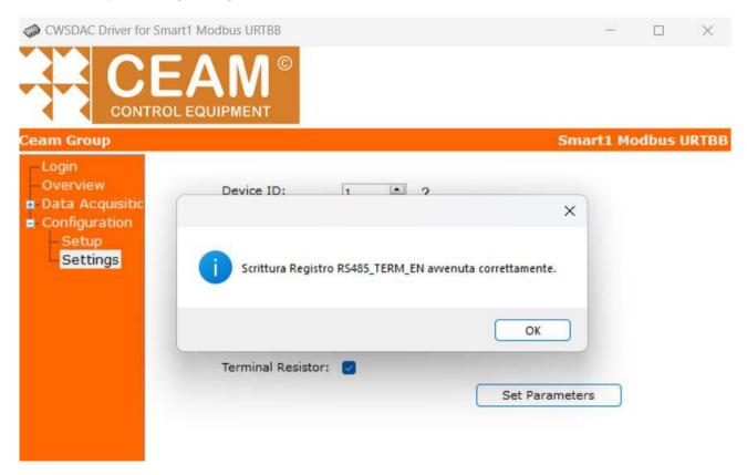
Nel caso di modifica dei valori degli altri registri, poiché questi sono parametri comunicazione con il dispositivo URT-BB, al termine della scrittura, il software obbliga al riavvio della Funzione Dispositivo, dopo l'applicazione delle modifiche apportate (figura seguente).
