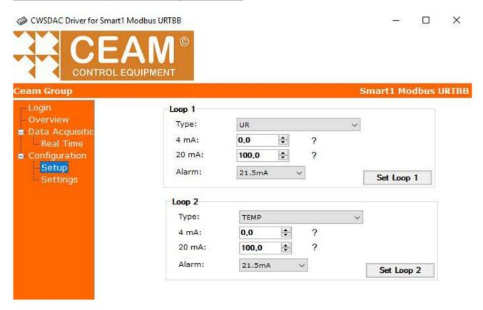
Tramite questa finestra è possibile definire il comportamento delle uscite analogiche Loop1 e Loop2 semplicemente impostando i parametri (descritti qui sotto) e poi premendo il pulsante 'Set Output 1' o 'Set Output 2'.
