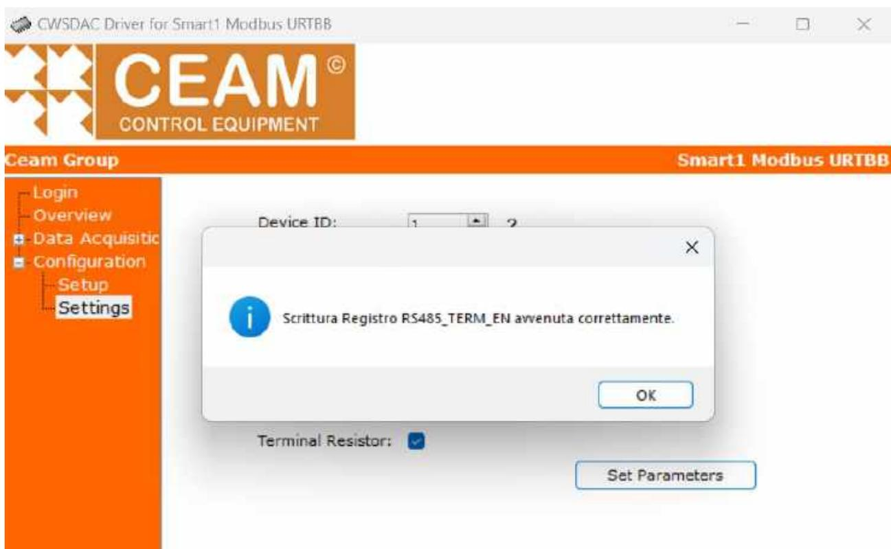
Nel caso di modifica dei valori degli altri registri, poiché questi sono parametri comunicazione con il dispositivo URT-BB, al termine della scrittura, il software obbliga al riavvio della Funzione Dispositivo, dopo l'applicazione delle modifiche apportate (figura seguente).
