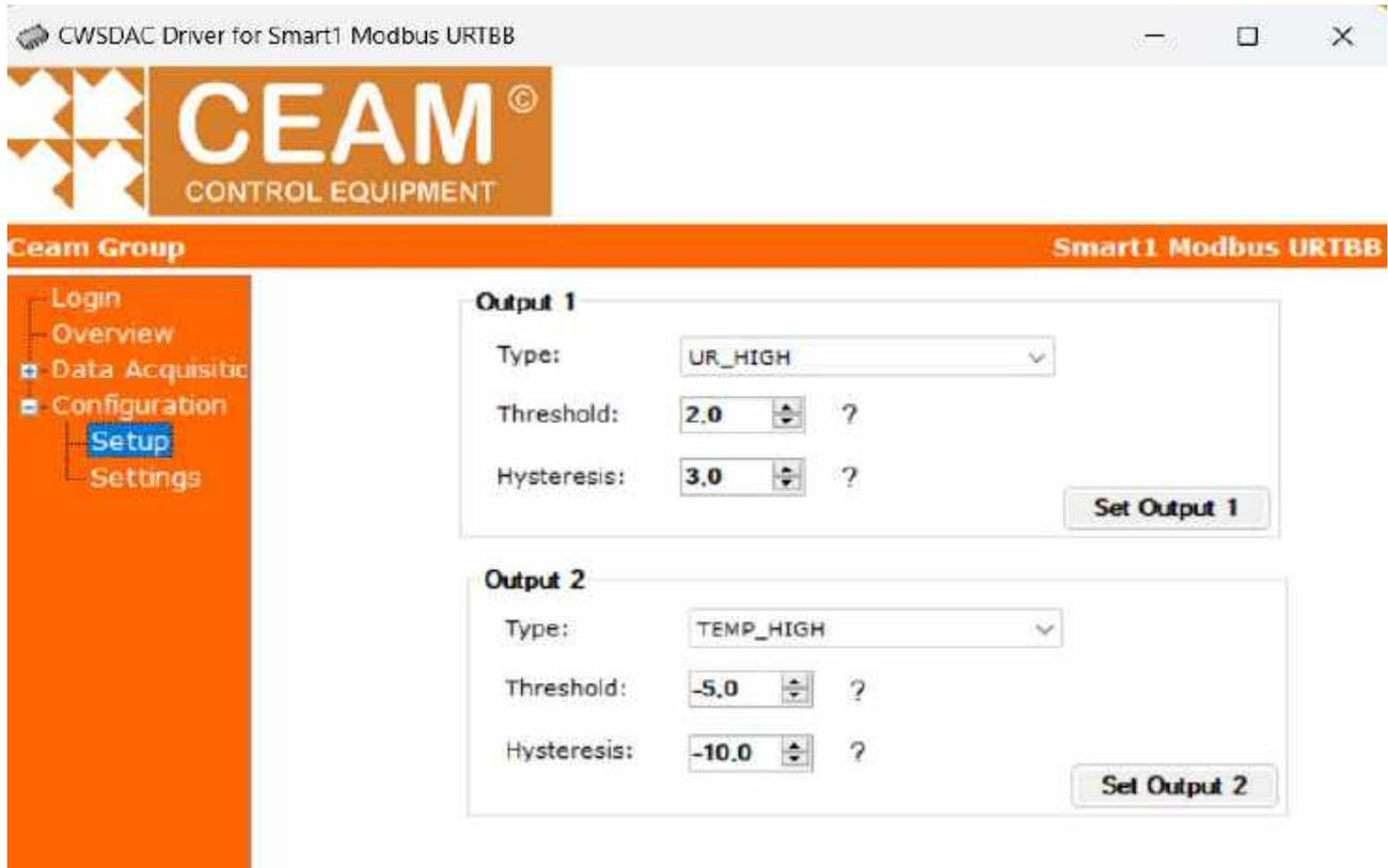
Tramite questa finestra è possibile definire il comportamento delle uscite digitali Output1 e Output2 semplicemente impostando i parametri (descritti qui sotto) e poi premendo il pulsante 'Set Output 1' o 'Set Output 2'.
