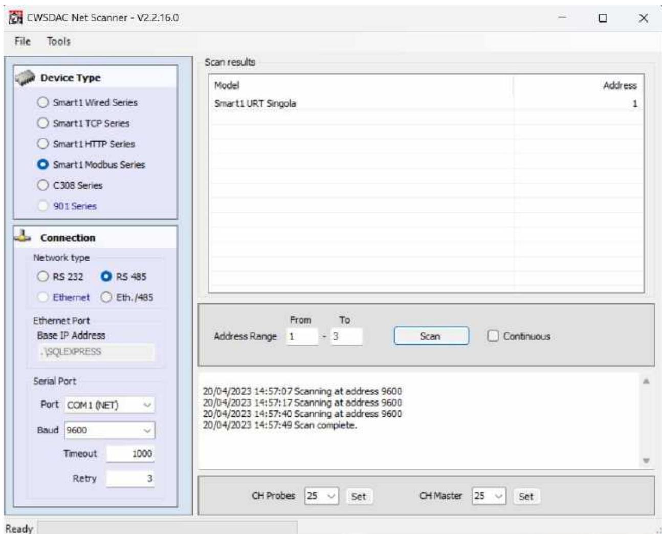
Nella Figura sopra, la configurazione tipica del tool Net Scanner per la ricerca dei dispositivi, in questo caso di tipo URTBB.
