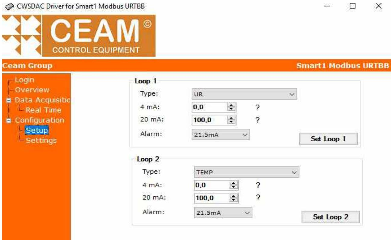
Tramite questa finestra è possibile definire il comportamento delle uscite analogiche Loop1 e Loop2 semplicemente impostando i parametri (descritti qui sotto) e poi premendo il pulsante 'Set Output 1' o 'Set Output 2'.
